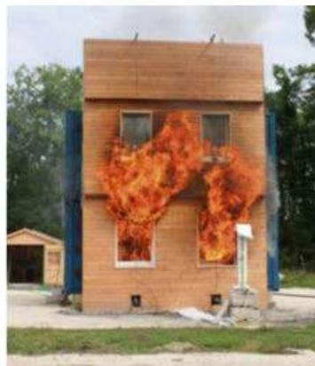
*Figure 11 – essai de propagation du feu sur une façade à trois niveaux*
