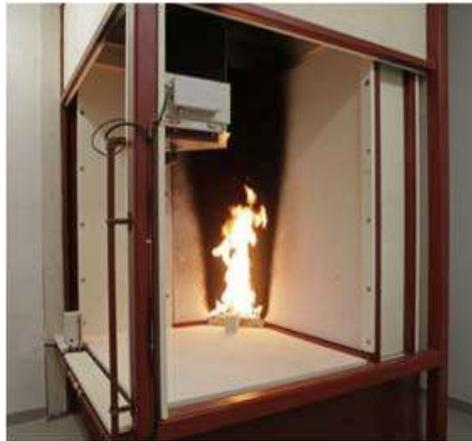
*Figure 10 – essai d'incendie sur un angle de façade rentrant*
