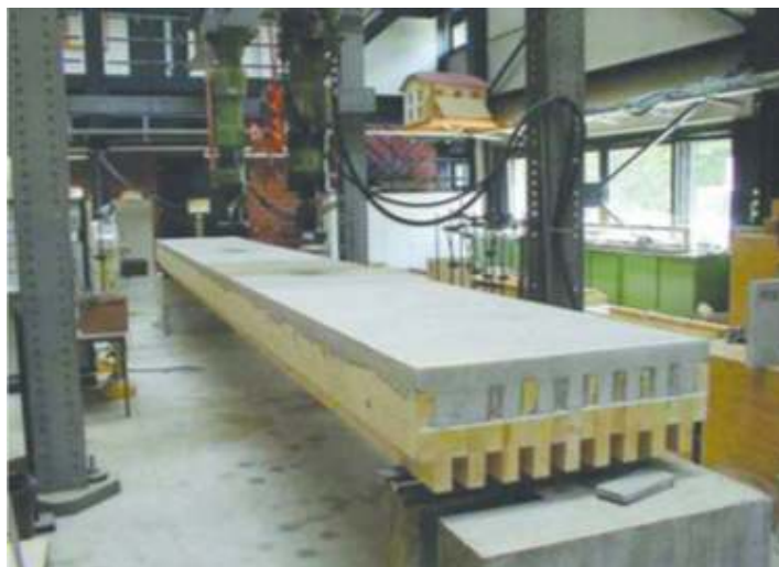
Figure 4 - Elément de plancher mixte bois-béton
